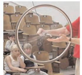
Lorsqu'on incline dans un sens l'axe d'un objet qui tourne, il s'incline par lui-même dans un autre sens, qui forme un angle droit avec le premier. Ce mouvement est appelé **précession**.
